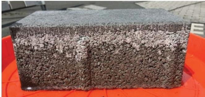
Abbildung 7: Detailaufnahme vom zweilagigen Hybrid-Pflasterstein mit undurchlässigem Vorsatz (Aqua Urbanica, Dierkes, 2019)
