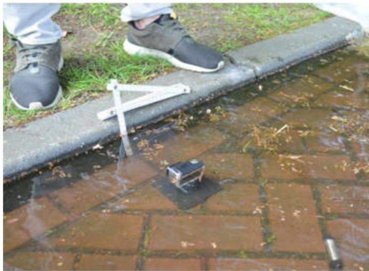
Abbildung 51: Automatische Wasserstandsmessung, Handmessung und Unterwasserkamera (Boogaard et al. 2019)
