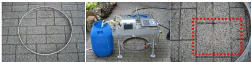
Abb. 80: Objekt 16: Prüf-Fläche (li.), Versickerungsversuch (Mitte), heraus gespülter Sand (re.)
