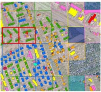
Abbildung 24.10.: Auswertung Zeilenbebauung: Gitterzelle 1 weist in allen Parametern eine gute Übereinstimmung vor, Gitterzelle 4 annähernd.
