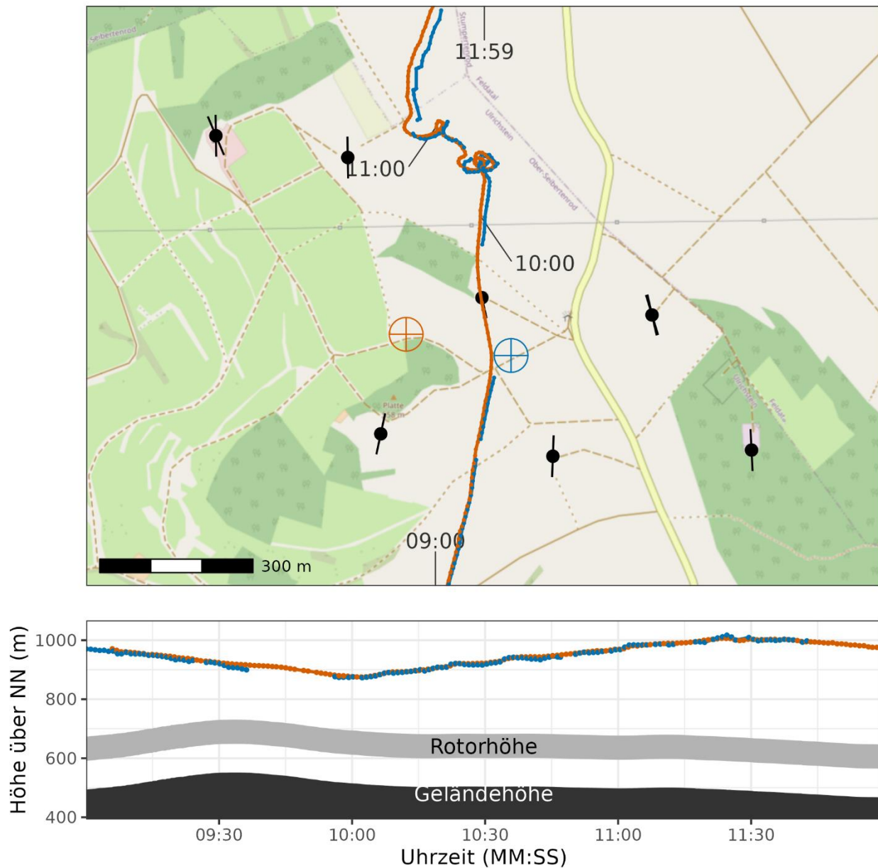
Abbildung 64: Rotmilan-Flugbahn oberhalb der WEA ohne Ausweichreaktion. In der Kartendarstellung sind farblich kodiert die Messpunkte der 2 IDF-Systeme als Punkte eingetragen. Die Fadenkreuze stellen die jeweiligen Standorte der IDF-Systeme dar. Die WEA sind als schwarze Punkte eingezeichnet. Die zeitgleiche Rotorstellung(en) ist als schwarze Linien dargestellt. Die untere Grafik zeigt den Flughöhenverlauf der Rotmilanflugbahn. Die IDF-Messpunkte sind, gleich wie in der Karte, farblich unterschieden. Zusätzlich wird die Geländehöhe unter den jeweiligen Messpunkten als dunkelgrau unterlegte Fläche dargestellt. Aus der Geländehöhe abgeleitet wird darüber, hellgrau unterlegt, das Höhenband dargestellt, welches vom Rotor der WEA durchstreift wird.
