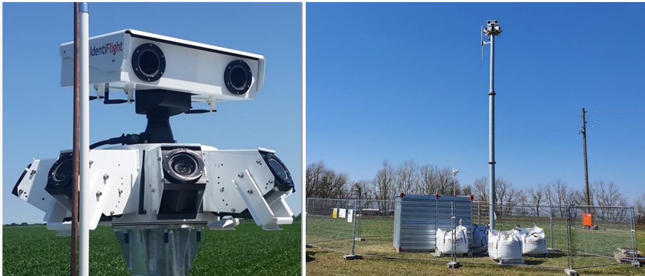
Abbildung 1: Kamerakopf eines IDF (links) und Aufbau auf einem 10 m hohen Mast mit Container (rechts)
