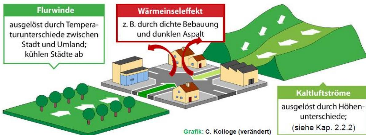
**Abbildung 5 |** Schematische Darstellung von Wärmeineffekt, Flurwinden und orographischen Kaltluftströmungen (KOLLOGE 2012, verändert)
