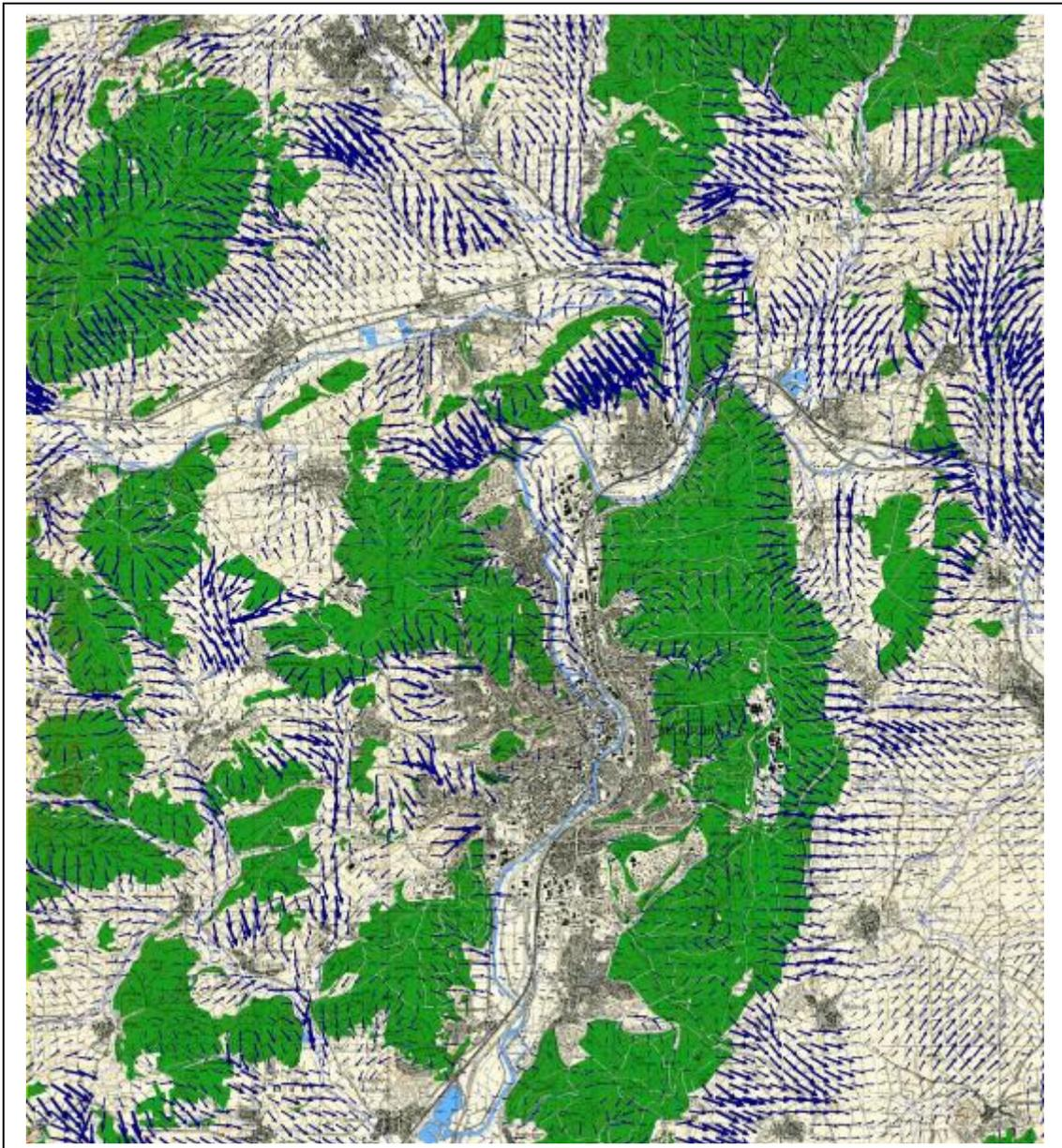
**Abb. 6-5:** Bodennahe mittlere Strömung (10 m über Grund) später in der Strahlungsnacht, mehr als 3 Stunden nach Sonnenuntergang bzw. in der zweiten Nachthälfte. Die Strömung ist dargestellt durch Vektoren an jedem 2. Berechnungspunkt. Die Länge der Vektoren ist ein Maß für die lokale Geschwindigkeit.
