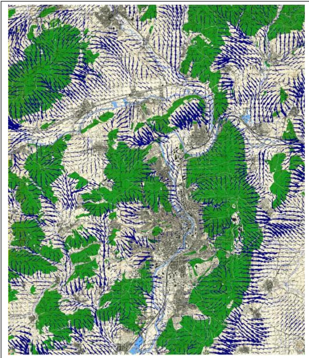
**Abb. 6-2:** Bodennahe mittlere Strömung (10 m über Grund) zu Beginn einer Strahlungsnacht, ca. 1 bis 2 Stunden nach Sonnenuntergang. Die Strömung ist dargestellt durch Vektoren an jedem 2. Berechnungspunkt. Die Länge der Vektoren ist ein Maß für die lokale Geschwindigkeit.
